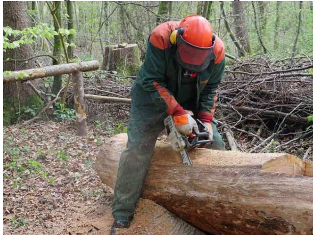
Abbildung 101 Tiefschnitte für die Bottichwände
