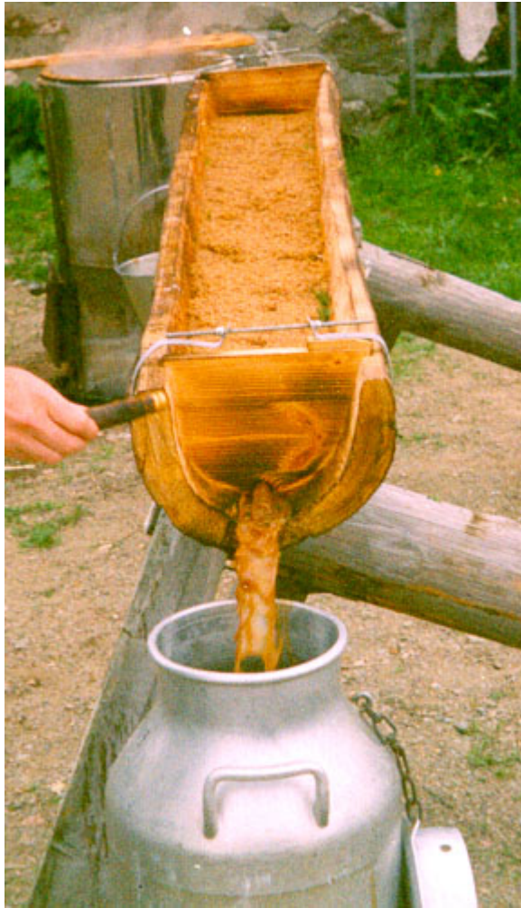
Abbildung 71 Kuurna-Trog mit Endbrettern. Quelle: (Likovuori, 2001), der das Buch Ilkka Sysil: "Small Scale Brewing" zitiert
