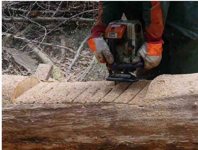
Abbildung 103 Bottichkern in Scheiben zersägen
