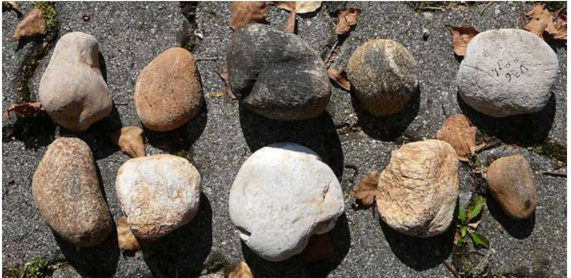
Abbildung 78 Kochsteine, die ein Erhitzen auf 450°C bis 620 °C gut überstanden
