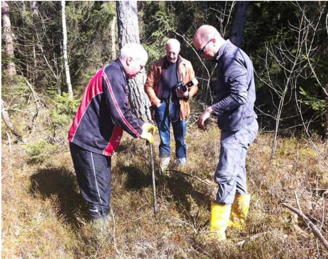
Abbildung 1 Dr. Michael Peters treibt das oberste Segment der Probenröhre in den Boden des Haspelmoors
