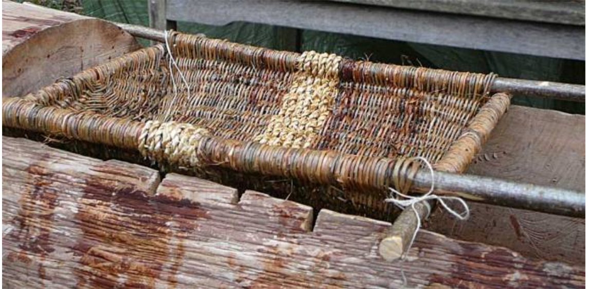
Abbildung 81 Läuterkorb paßgenau gefertigt für einen Einbaum-Brautrog
