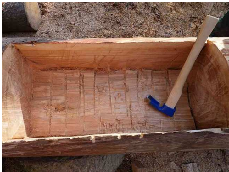
Abbildung 105 Troginneres bei der Nachbearbeitung
