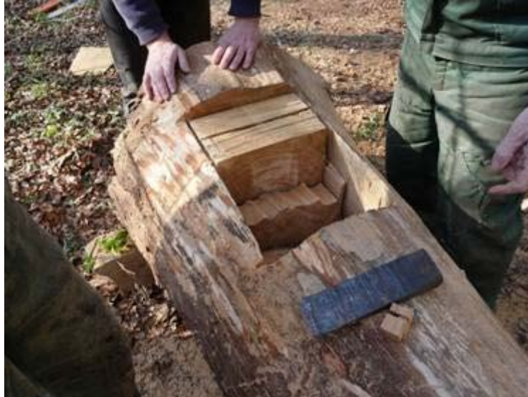
Abbildung 104 Kernscheiben mit dünnem (und dickem) Keil herausschlagen
