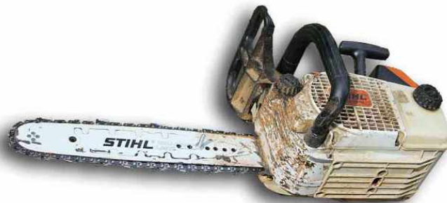
Abbildung 100 Einhandsäge mit Bohrungen im Schwert und einer Schraube als Tiefenanschlag
