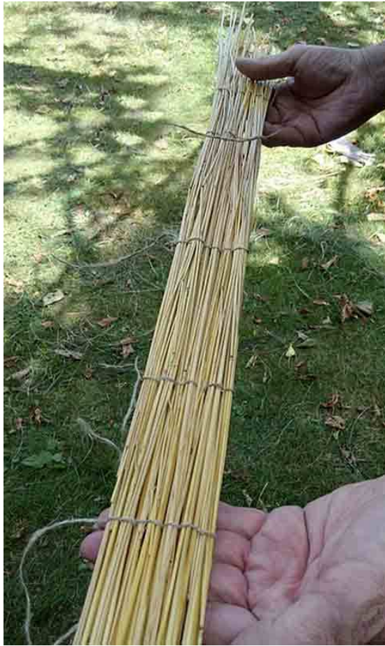
Abbildung 89 Prototyp einer Grasmatte, die mit gezwirnten Hanffasern verbunden ist
